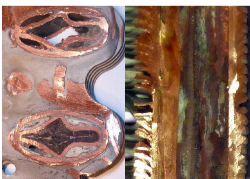
Рис.2 Теплообменник с отложениями накипи
