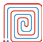
Бифилярная укладка «теплых полов».
