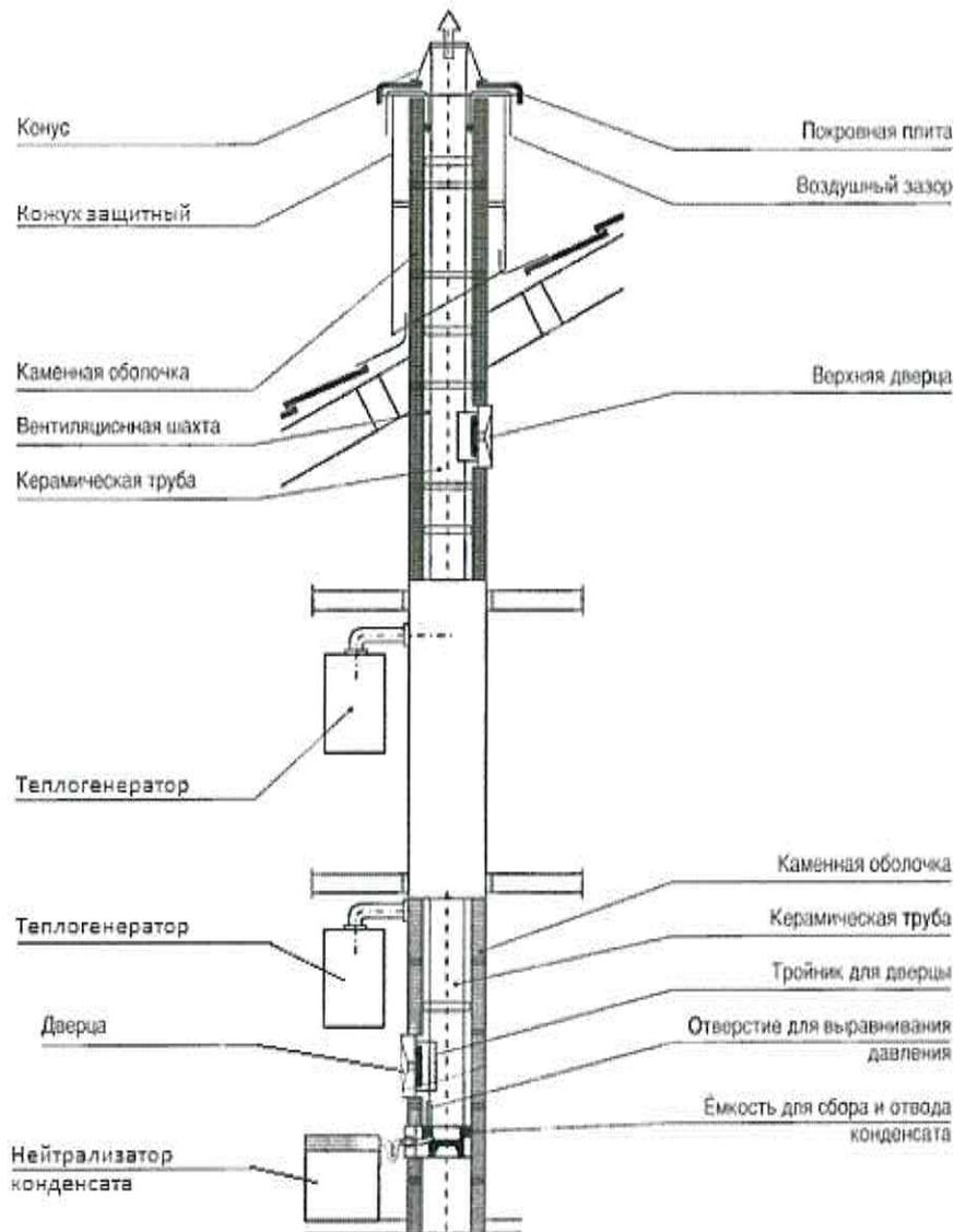
1 – покровная плита; 2 – воздушный зазор; 3 – верхняя дверца; 4 – каменная оболочка; 5 – керамическая труба; 6 – тройник для дверцы; 7 – отверстие для выравнивания давления; 8 – емкость для сбора и отвода конденсата; 9 – нейтрализатор конденсата; 10 – дверца; 11 – нейтрализатор конденсата; 11, 12 – теплогенератор; 13 – защитный кожух; 14 – конус
