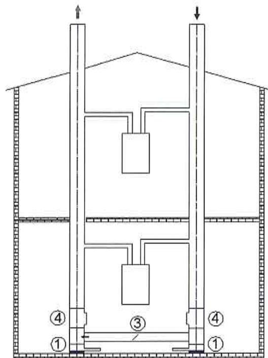
① – слив конденсата; ③ – стабилизатор тяги; ④ – прочистка дымохода
