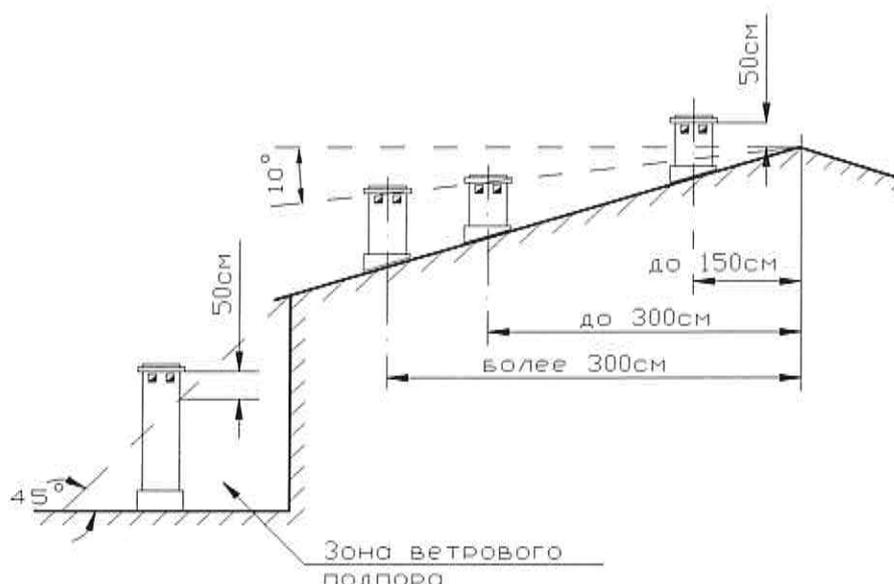
**Рисунок 6.1 – Высота дымоходов в зданиях**
