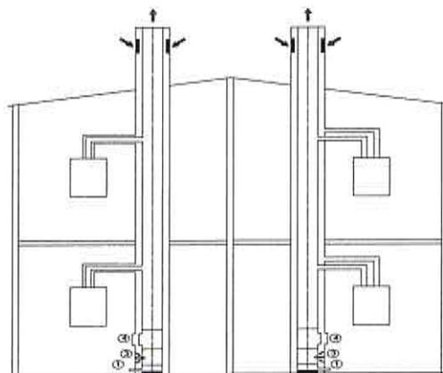
① – слив конденсата; ③ – стабилизатор тяги; ④ – прочистка дымохода
