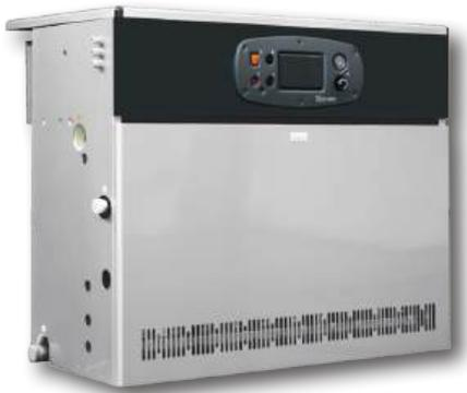
Серия SLIM HPS – это серия высокоэффективных газовых котлов с атмосферной горелкой. Секционный теплообменник из высокопластичного чугуна с профильными ребрами имеет большую поверхность теплообмена и отличные аэродинамические свойства. Благодаря тепловой изоляции из стекловолокна, размещенной под кожухом, потери тепла минимальны.
