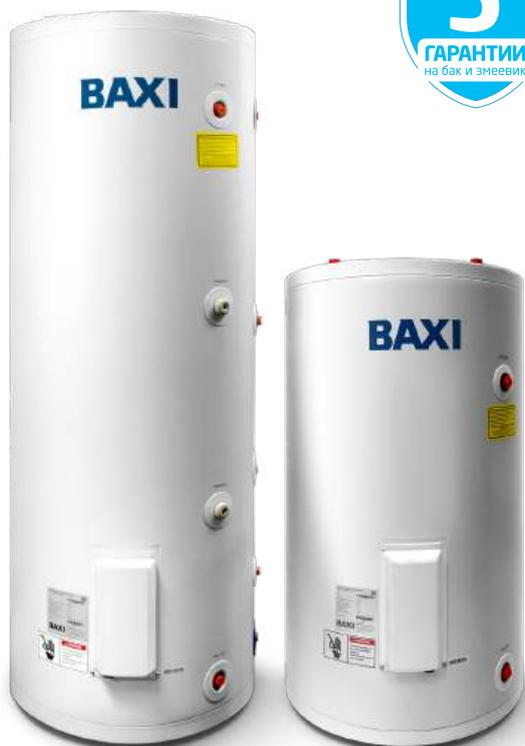
Внешние накопительные бойлеры серии UBC – это высокоэффективные эмалированные стальные водонагреватели емкостью от 100 до 500 литров. Стенки и змеевик бойлера покрыты запатентованной высококачественной эмалью. Для дополнительной защиты от коррозии бойлеры оснащены магниевыми анодами. Благодаря изоляции из пенополиуретана толщиной от 40 до 50 мм (в зависимости от емкости) потери тепла минимальны. Широкий модельный ряд дает возможность выбрать бойлер, оптимально подходящий для вашего комфорта.
