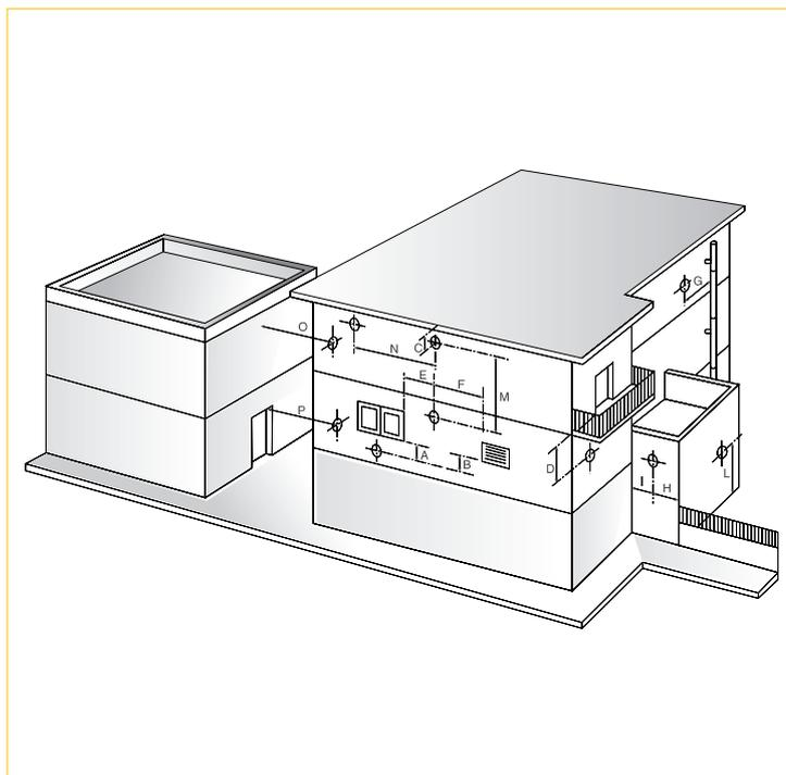
В пространство, ограниченное с четырех сторон, но открытое сверху (вентиляционные шахты, колодцы, внутренние дворики и т.п.) допускается напрямую выводить продукты сгорания газовых отопительных приборов с естественной или принудительной тягой и мощностью от 4 до 35 кВт при обязательном соблюдении следующих условий:
