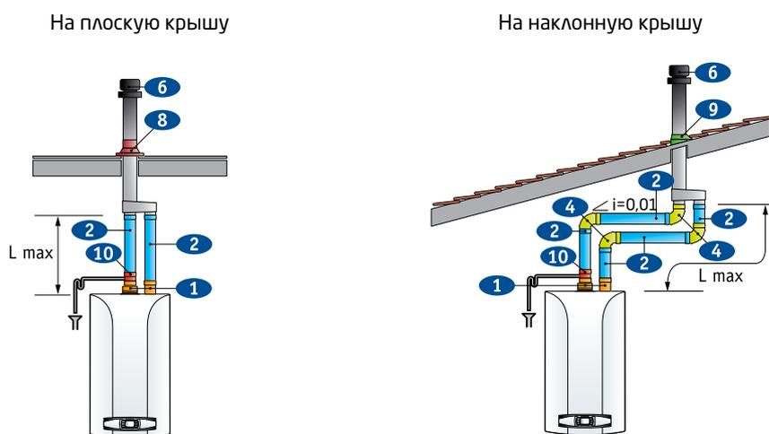
**Примечание:** 1. Раздельные трубы для отвода продуктов сгорания и забора воздуха не должны выходить на противоположные фасады здания. Общая длина труб забора воздуха не должна превышать 10 метров. При длине дымохода более 6 м комплект для сбора конденсата (поставляется отдельно) должен монтироваться в непосредственной близости от котла.
