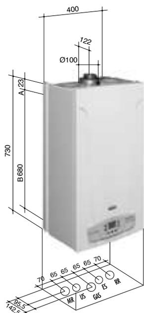
MR: Подача в систему отопления 3/4" м
