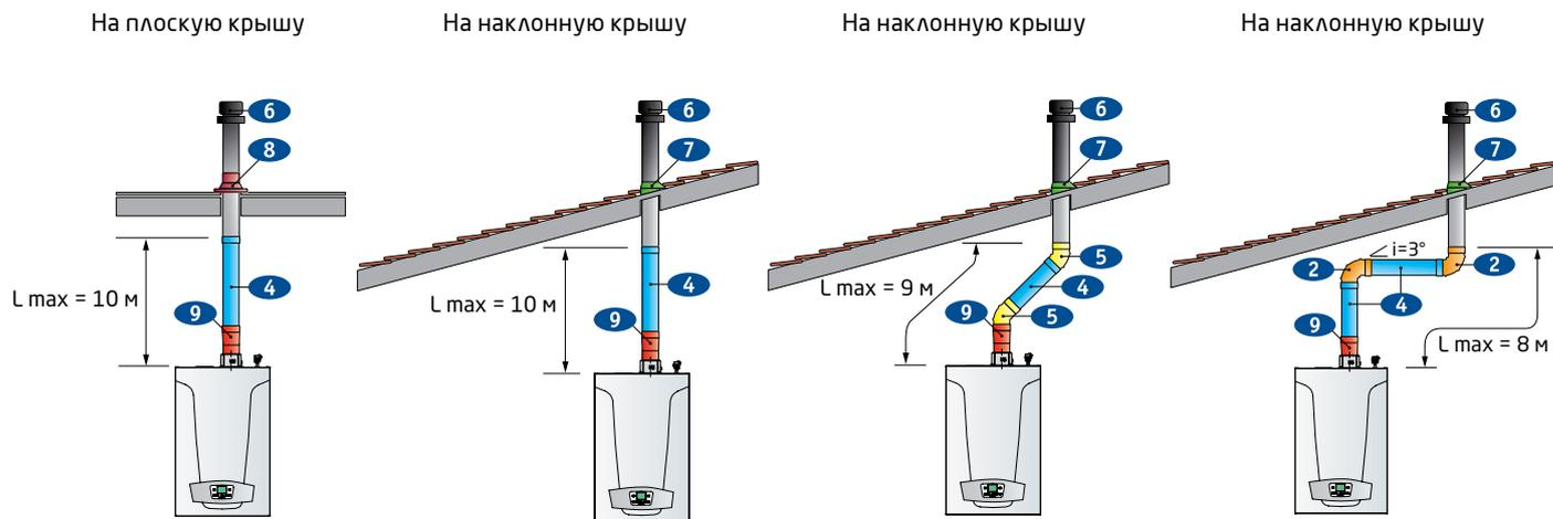
**Примечание:** На схемах указан уклон и его направление.  $i=3^\circ$  означает уклон в  $3^\circ$ , который предусмотрен конструкцией дымовых труб для конденсационных котлов.
