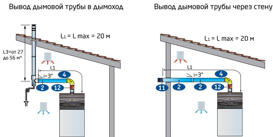
**Примечание:** Максимальная длина дымовых труб до вертикального ствола дымохода не более 20 м для всех моделей (не более 30 м для POWER HT 1.450).
