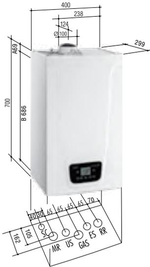
MR: Подача в систему отопления 3/4" m
