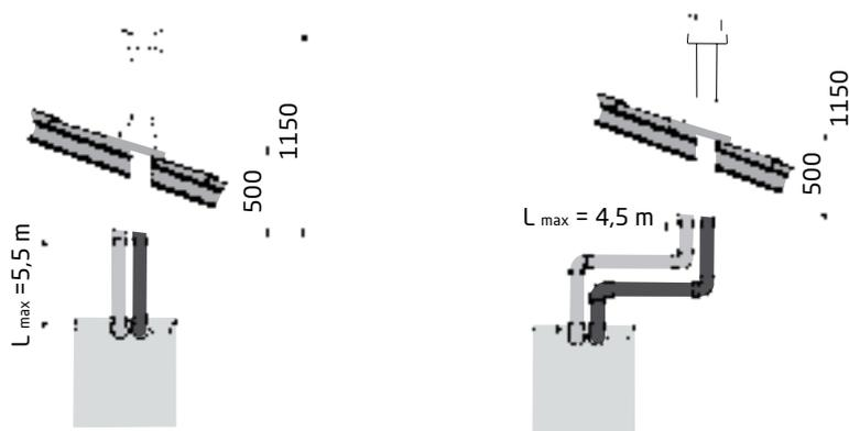
**Примечание:** Раздельные трубы для отвода продуктов сгорания и забора воздуха не должны выходить на противоположные фасады здания. Общая длина труб забора воздуха не должна превышать 10 метров. При длине дымохода более 6 м комплект для сбора конденсата (поставляется отдельно) должен монтироваться в непосредственной близости от котла.
