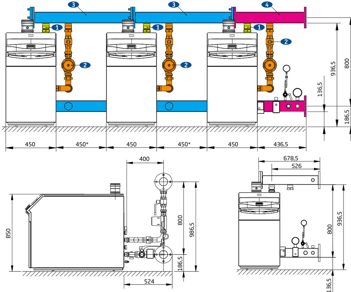
\* Есть также возможность более компактной установки котлов с дистанцией 2 см между ними (см. ниже поз. 3 в спецификации).
