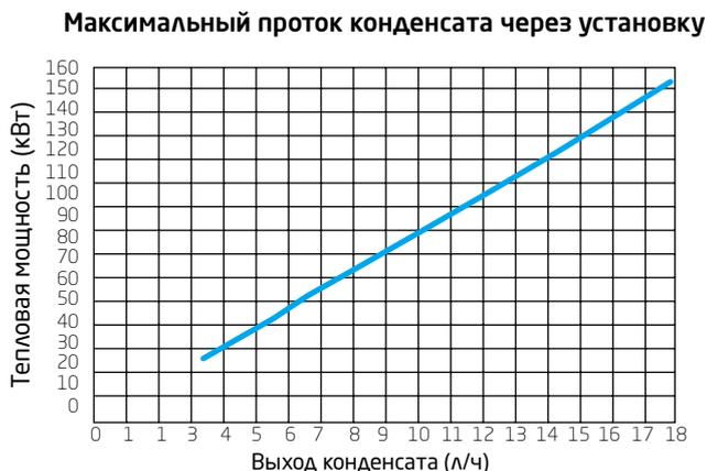
Из графика можно определить максимально возможное количество конденсата в зависимости от потребляемой мощности для всех моделей конденсационных котлов. При следующих условиях:
