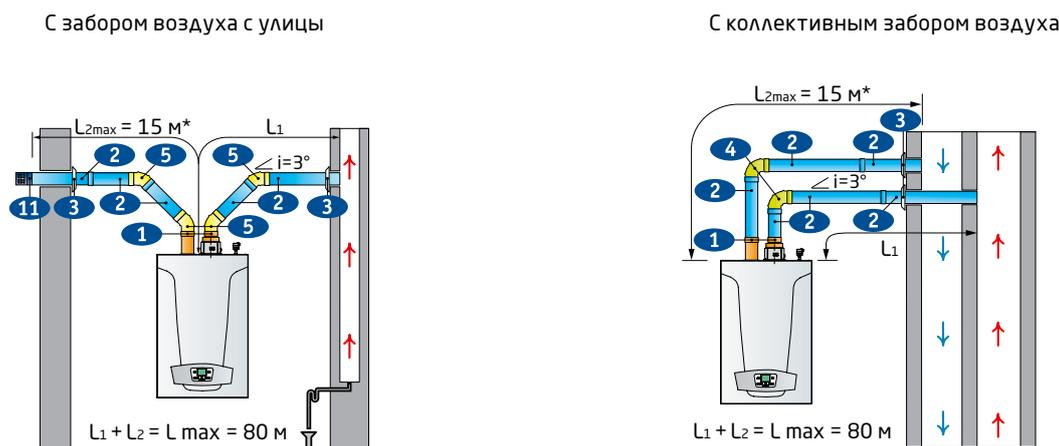
\*L<sub>2max</sub>=10 м (для LUNA Duo-tec MP+ 130–150 кВт)
