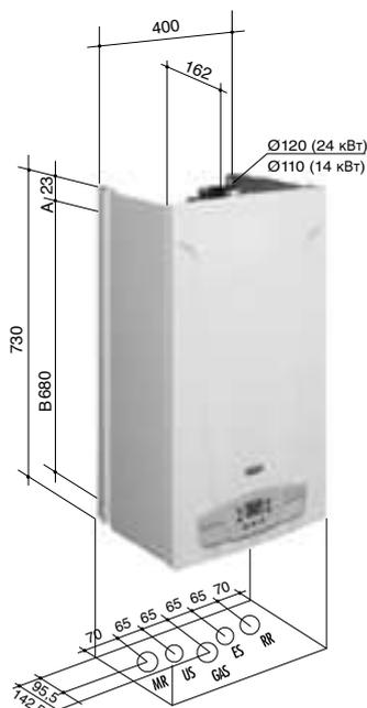
MR: Подача в систему отопления 3/4" m
