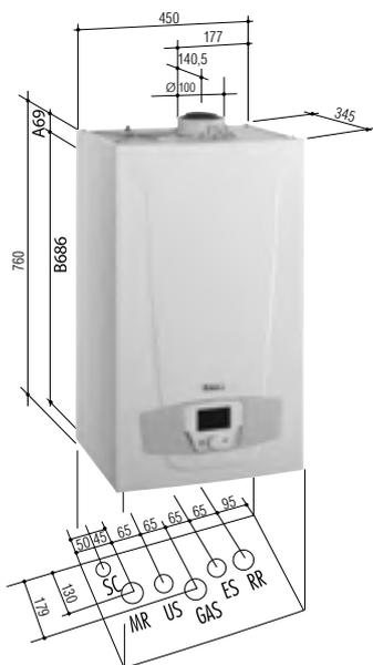
MR: Подача в систему отопления 3/4" m
