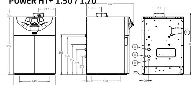
Присоединение раздельных диам. 80/125 мм и коаксиальных труб диам. 80 мм
