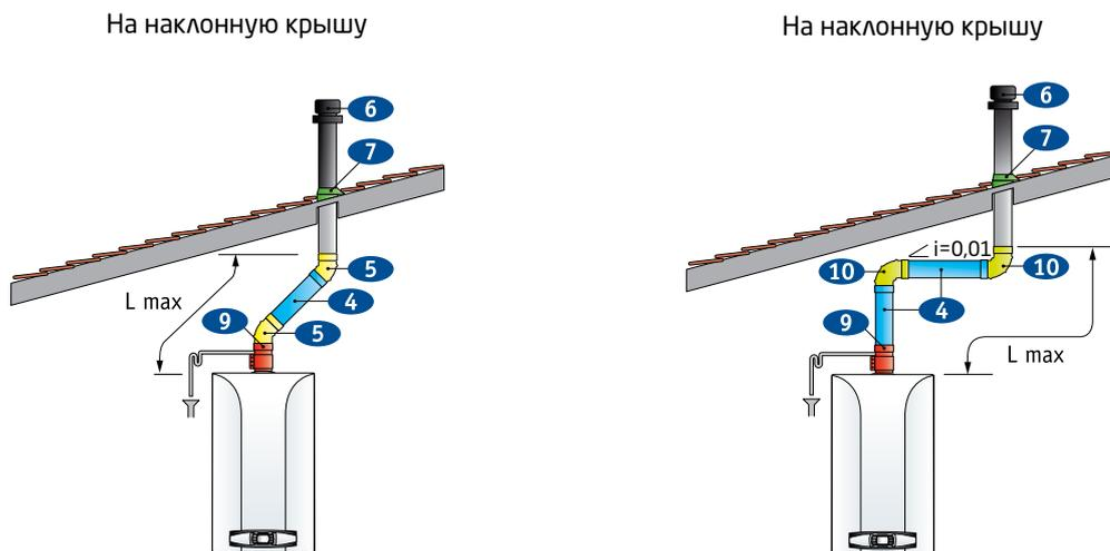
**Примечание:** На схемах указан уклон и его направление.  $i=0,01$  означает уклон не менее 1 см на каждый 1 м длины дымовой трубы.
